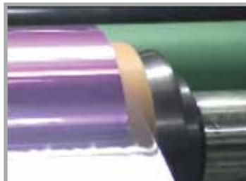
また、密閉タイプを採用したことによって、作業雰囲気（②安全性）と、液の濃度変化を改善することができ（③安定性）、さらには縦搬送によって、張力の掛けられない伸びやすいプラスチックフィルムでも面均一な塗工（④均一性）が可能となった。
